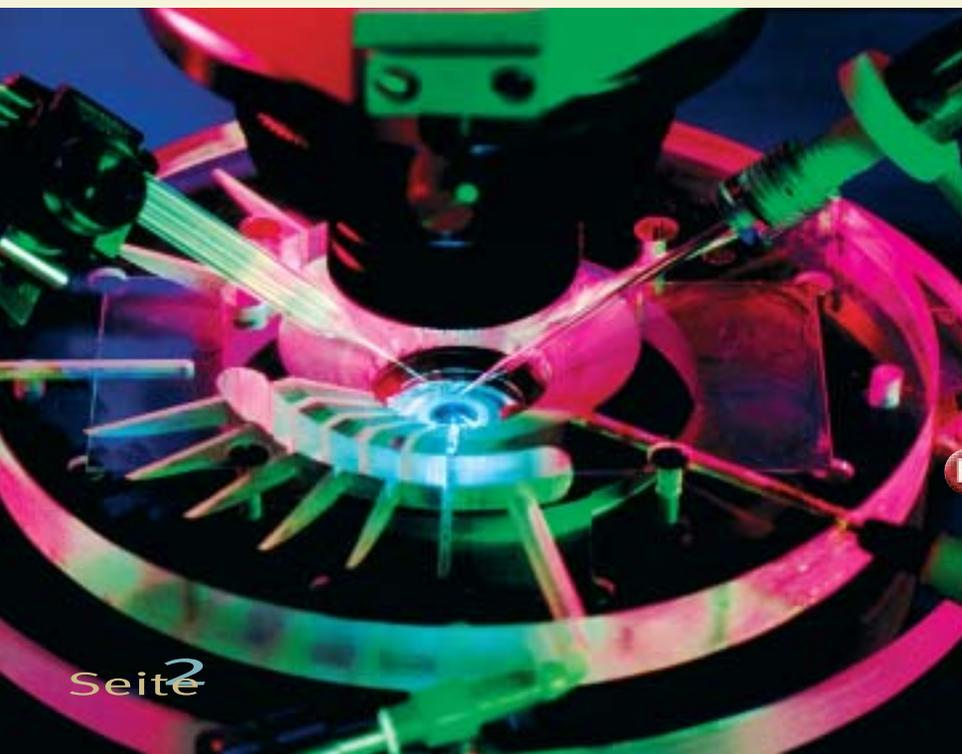
◀ Durch einen halboffenen Käfig (kleines Bild oben) wird die Messapparatur im Labor vor elektrisch störenden Einflüssen abgeschirmt. Detailbild (links) von der Mess- und Haltepipette unter dem Mikroskopobjektiv bei einer Patch-Clamp-Messung. (Fotos: Wolfgang Filser)
