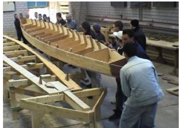
Abb. 1: Bau des Holzdrachenboots (Quelle: Rolf Strojec)
