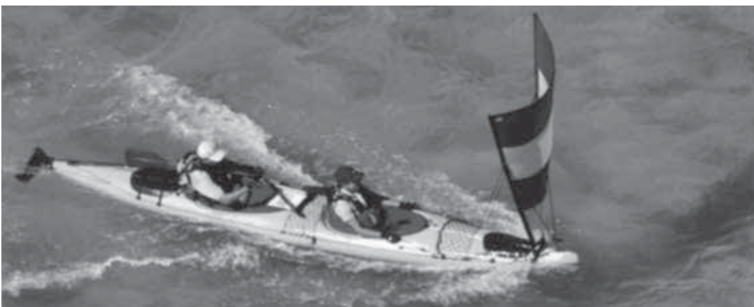
Abb.: Kajaksegel der Firma Prijon: ein großer langer Zweisitzer mit einer Mastlänge von über zwei Metern und einer Segelfläche von 2,2 m 2 .
