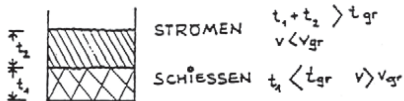
Abb.: Strömender und schießender Abfluss in einem Normgerinne schematisiert dargestellt.
