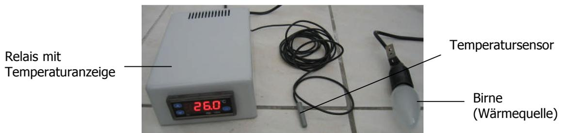
Abb. 4: Thermoregulator (Selbstbau)
